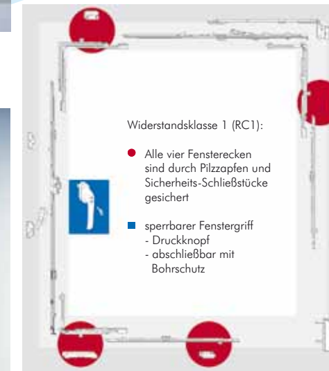
Schließstück zur Aufnahme der Pilzkopfverriegelung.
